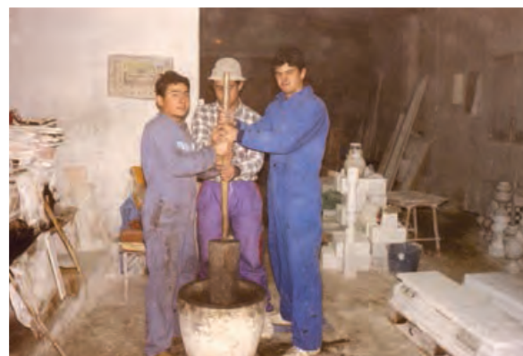
► Proceso de macear la pólvora en un gran mortero de mármol con una gran maza que hace necesario la fuerza de varias personas. (Colección: José M. Aránega Fernández).
